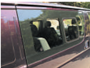
車窗新增中排兩邊的橫趟式設計，令車廂內的空氣格外流通
