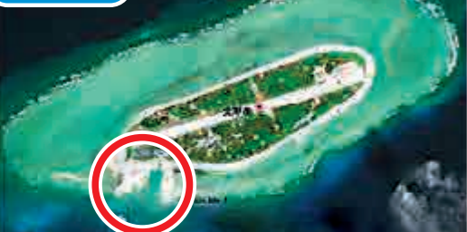
2012年新建碼頭工程尚未啓動，島內西南角尚未出現填海人工陸塊 2015年西南角因建太平島碼頭，出現大型人工填海新陸塊
